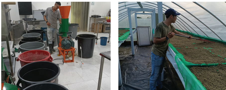
Figura 9. Proceso de fabricación de alimento balanceado para peces en la sede Orinoquía: molido de materias primas, mezclado, hidratación de la mezcla, peletizado y secado solar del pélet Fuente: elaboración propia.
